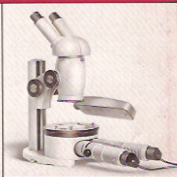
Stereomikroskop IVb mit Zoom-System 0,8x...5x und für Fotografie
