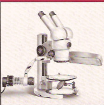
Stereomikroskop III mit Zoom-System 1x...4x
