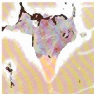
Covellin mit Kupferglanz, Kupferkies und Pyrit; aufgenommen mit Objektiv EPI-Achromat 16/0,40 Coel Pol im einfach polarisierten Licht. Aufnahme: Dr. H. Piller, Carl Zeiss, Oberkochen
